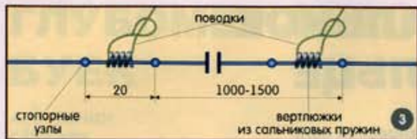
3. Фиксация поводков с мушками на мотовильце.
